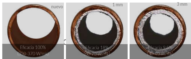
Efecto de la incrustación en la eficiencia térmica
